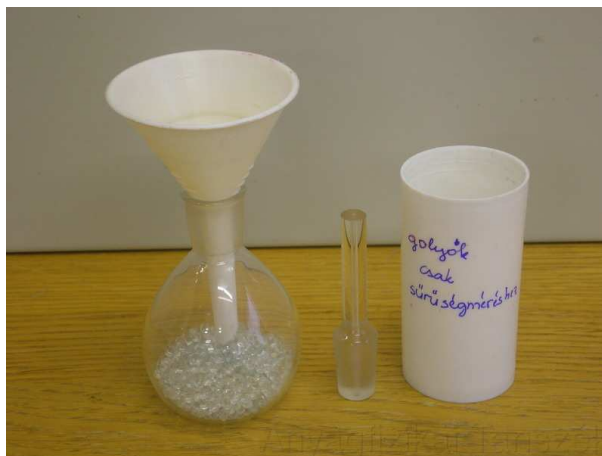
3.ábra. Piknométer és golyók a golyósűrűség meghatározásához.
