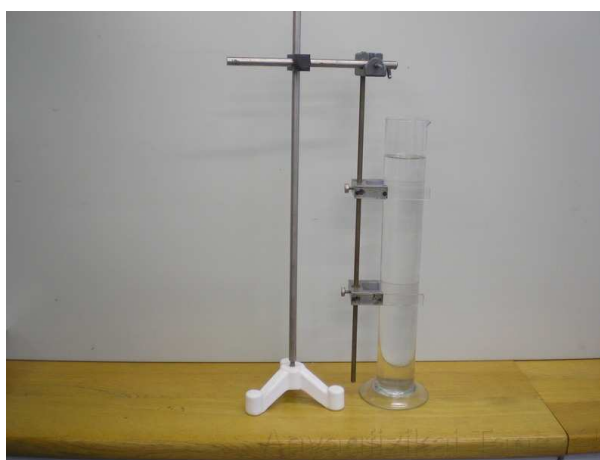
2. ábra. Glicerinnel töltött mérőhenger helyzetjelzőkkel.
