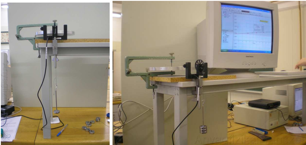
2.ábra. Forgómozgás kísérleti megvalósítása.
