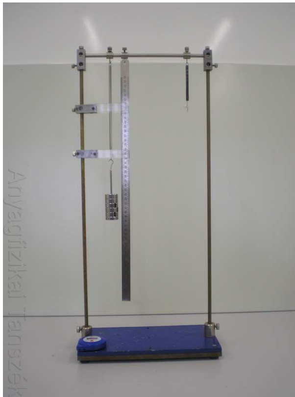
1.ábra. Mérőállvány rugókkal és ráakasztott súlyokkal
