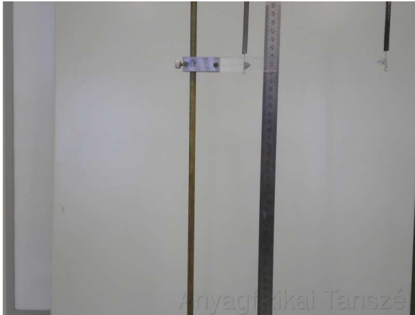
2. ábra. Terheletlen rugó helyzetének beállítása.
