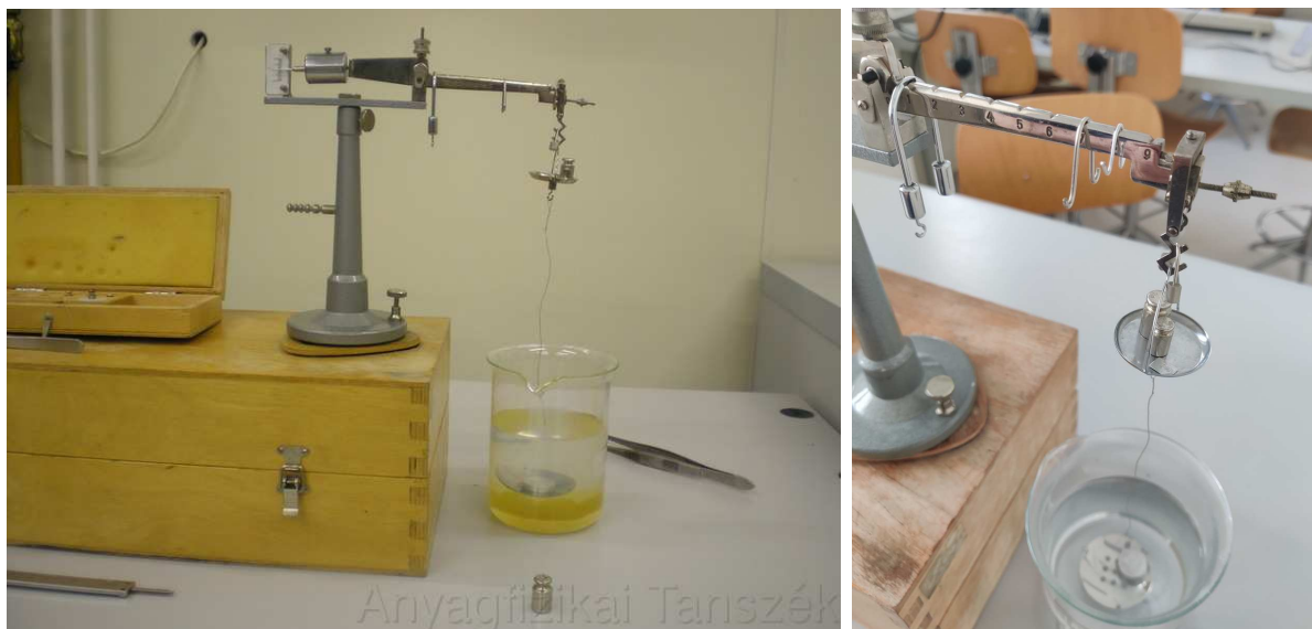
5. ábra. Térfogatméréshez a mintát a merülőtányérra helyezzük, majd a mérleget lovasok segítségével kiegyensúlyozzuk.
