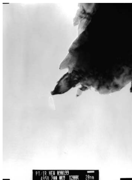
2. ábra. Pt-Ir tű hegye transzmissziós elektronmikroszkóppal (TEM) leképezve. A skálavonal hossza 20 nm. Forrás: http://www.physics.purdue.edu/nanophys/uhvstm/tip.html
