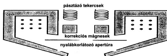
7. ábra. Az objektív lencse a pásztázó tekercsekkel, korrekciós mágnesekkel és az apertúrával
