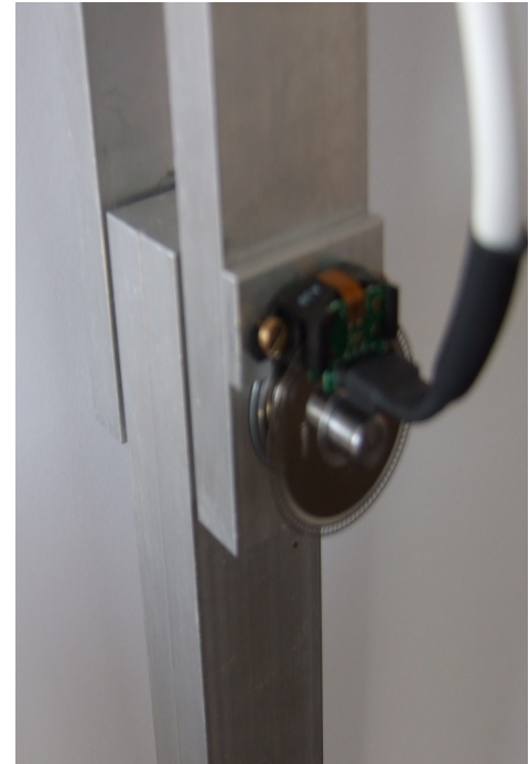
3.5. ábra: Az AEDB 9140 típusú digitális elfordulásmérő az ingára helyezve, védő doboz nélkül.
