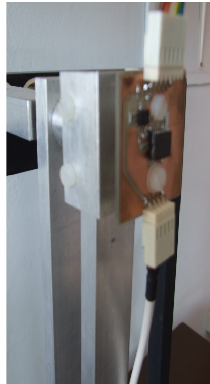
3.3. ábra: A gyorsulásszenzor forgástengely fölé helyezése
