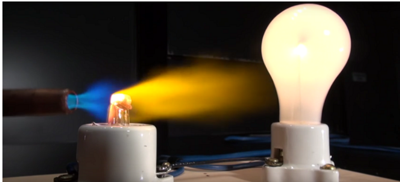
7. ábra. A hevített üvegdarab vezetőként viselkedett és zárta az áramkört
