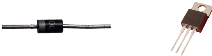
1. ábra. A dióda (balra) két-, a tranzisztor (jobbra) háromrétegű félvezető eszköz
