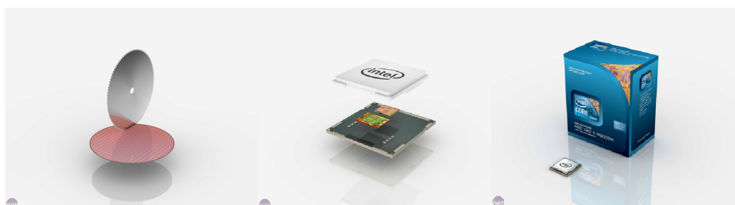
24. ábra. Kivágják az IC-eket és a tokozás elkészítése után csomagolják
