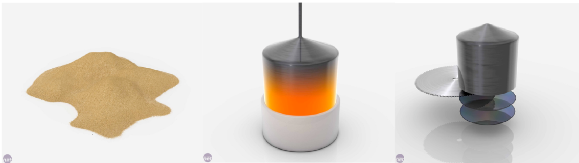
21. ábra. A homokból készült egykristályt feldarabolják
